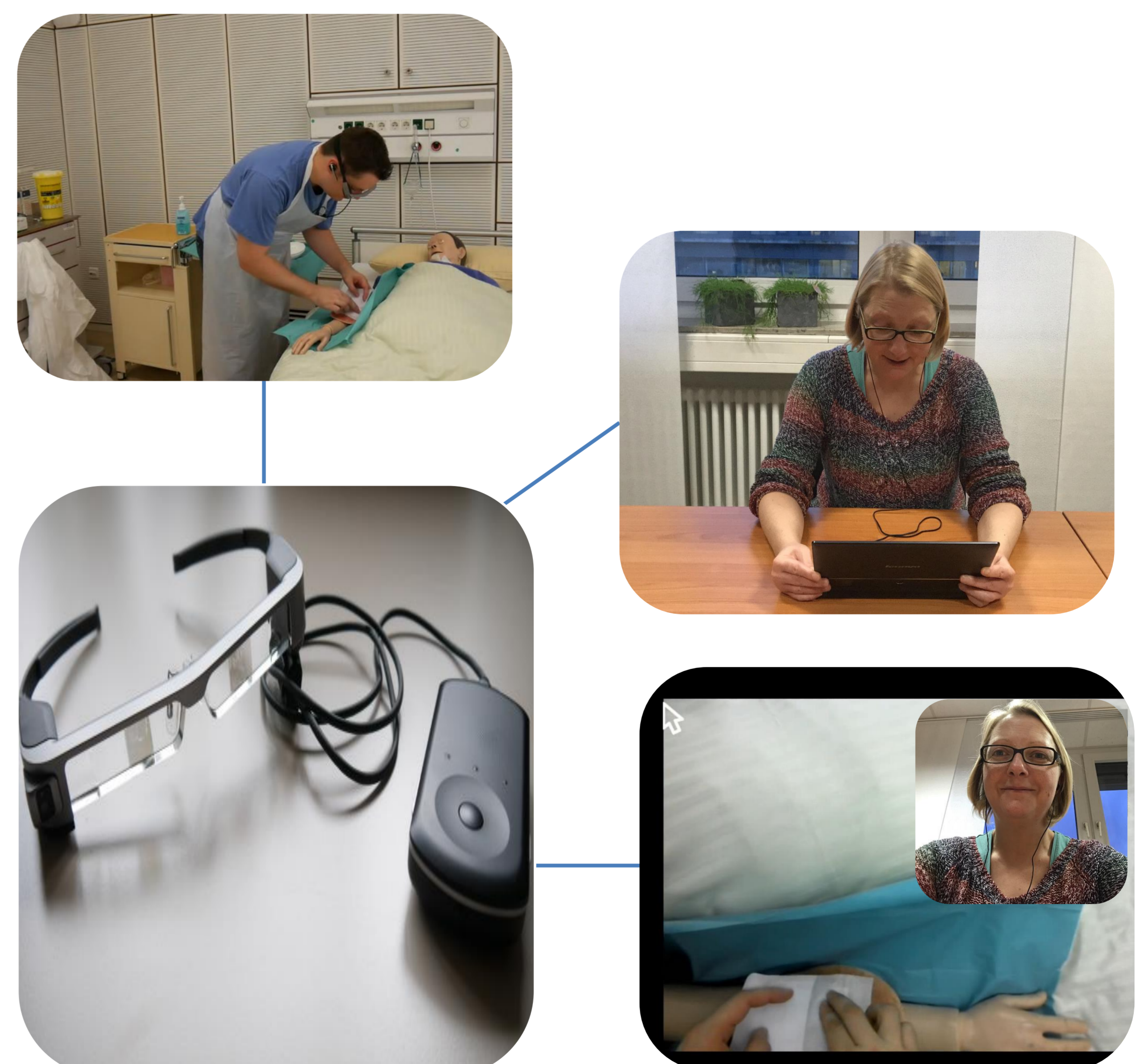
Abb. 3: Simulation einer Anleitung eines Mitarbeiters durch eine Pflegeexpertin in einem Skills-Lab. Die AR-Brille übermittelt das Live-Bild der Versorgungssituation auf das Tablet der Expertin, die dadurch die Versorgungssituation beurteilen und Anweisungen geben kann. (Bilder: TU Clausthal / UK Essen)
